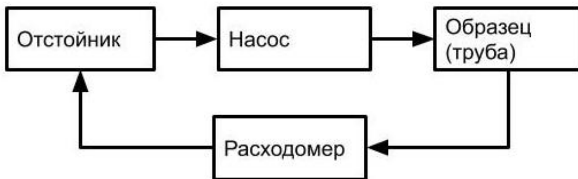
Рисунок 29. Схема циркуляции воды
