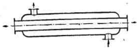
Фиг. 1-30. Элементный одноструйный теплообменник («труба в трубе»).
