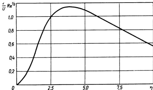
Рис. 7. Распределение поперечной скорости на пластине при постоянном расходе жидкости
