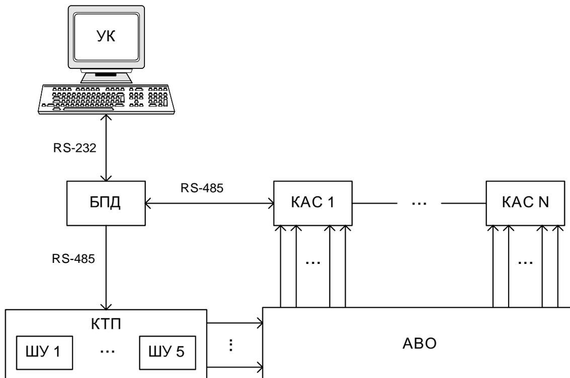
Рис. 1. Структурная схема САУ АВО газа
