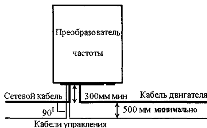
Рис. 15 Схема монтажа преобразователя частоты
