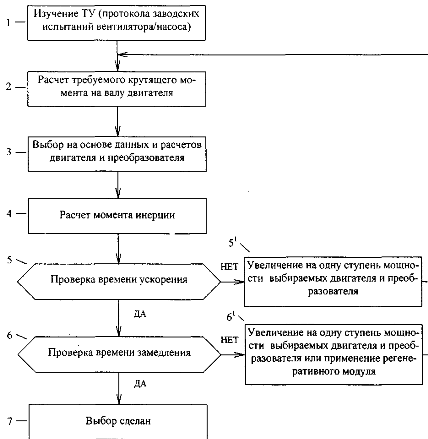
Рис. 2 Схема алгоритма выбора преобразователя частоты и двигателя для вентилятора/насоса
