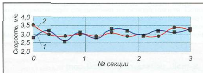
Рис. 14. Распределение скорости над одним из шести вентиляторов АВГ-85МГ за трубным пучком: 1 - поперек труб; 2 - вдоль труб
