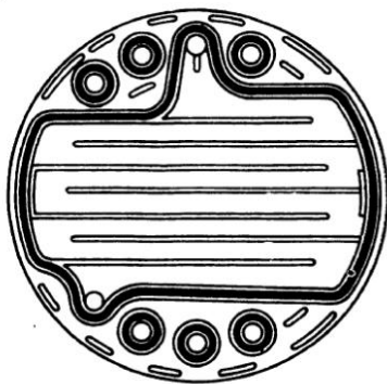
Рис. 40. Фрезерованная пластина канальчатого типа фирмы Бертуцци (Италия) для разборных аппаратов
