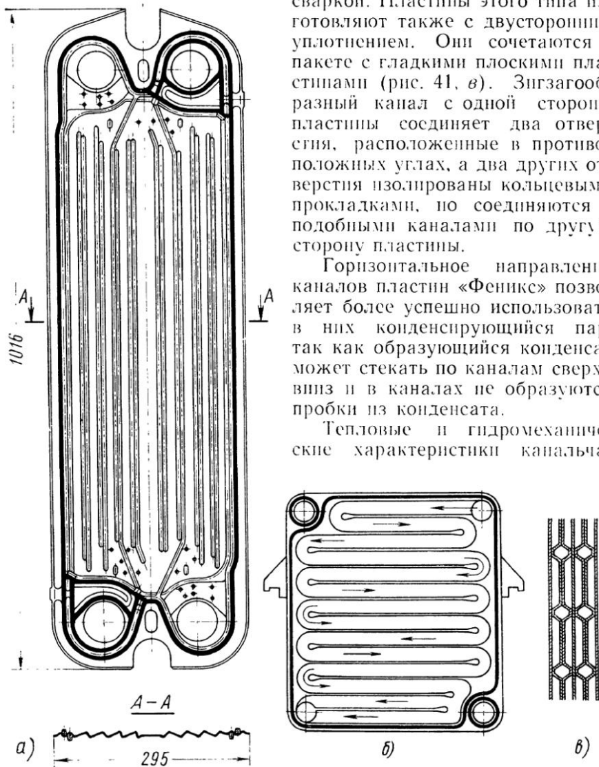
Рис. 41. Пластины канальчатого типа из штампованных элементов: а — «Астра» (ОПВ), б, в — «Феникс»
