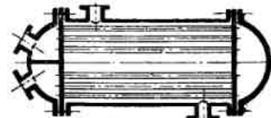
Рис. 101. Схема теплообменника с двумя неподвижно закрепленными трубными досками.
